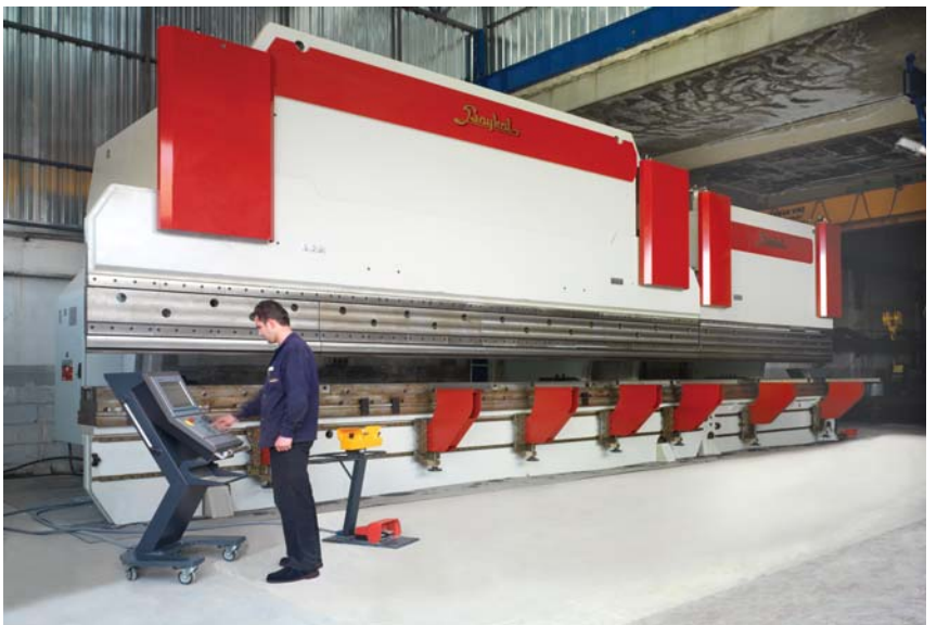
Abkant Pres Tandem Asimetrik 8100 / 4100 mm x 800 / 440 ton Press Brake Tandem Asymmetric 8100 / 4100 mm x 800 / 440 tons
