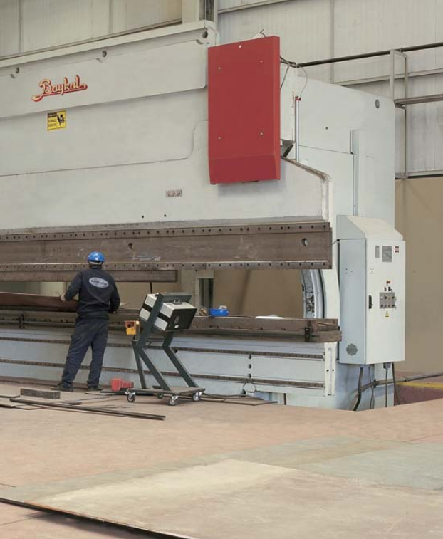
Abkant Pres Tandem 16200 mm x 2000 ton Press Brake Tandem 16200 mm x 2000 tons
