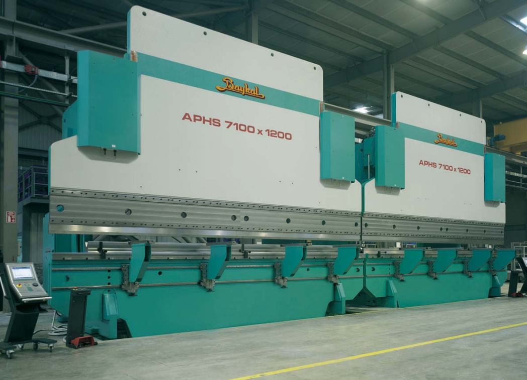
Abkant Pres Tandem 14200 mm x 2400 ton Press Brake Tandem 14200 mm x 2400 tons
