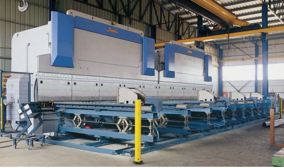
Abkant Pres Tandem 14200 mm x 1400 ton Press Brake Tandem 14200 mm x 1400 tons
